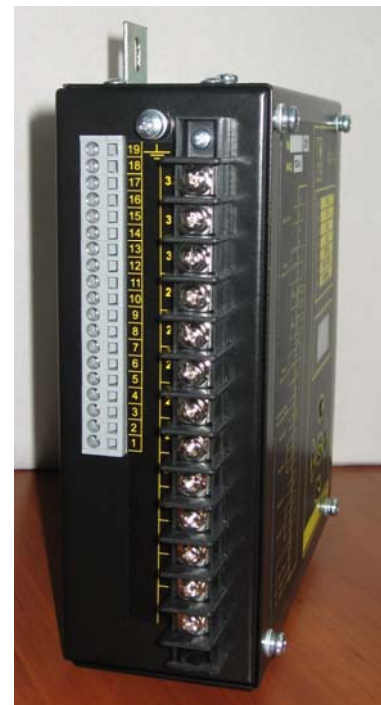
Внешний вид устройства REST.02/03 (TEZA-2/3) с креплением на узкой стороне
